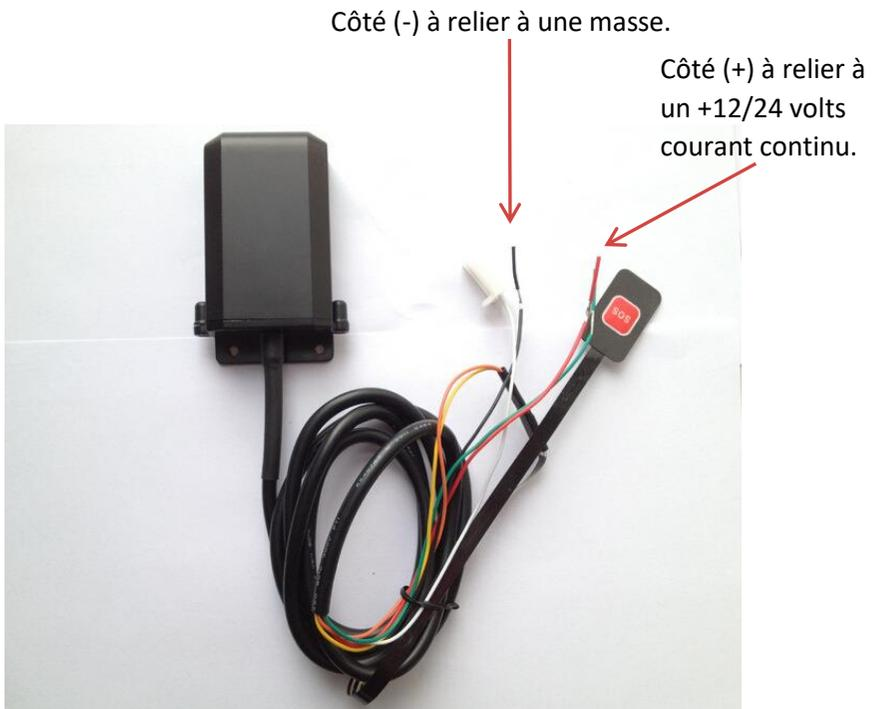
**Les autres câbles ne sont pas utilisés et doivent être isolés et ne pas entrer en contact.**
